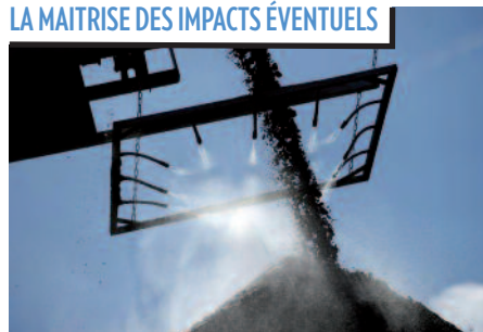
Système d'aspersion pour éviter l'envol de poussières
